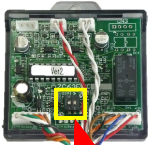
個別再生音切換えDIP S
